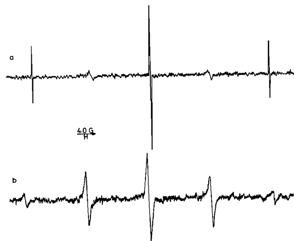
FIG. 1. Electron spin resonance spectrum of (a) (^{-}\text{O}_2\text{C}-\text{CH}_2)_2\dot{\text{C}}\text{CO}_2^{-} ; (b) (\text{HO}_2\text{CCH}_2)_2\dot{\text{C}}\text{CO}_2\text{H} .
